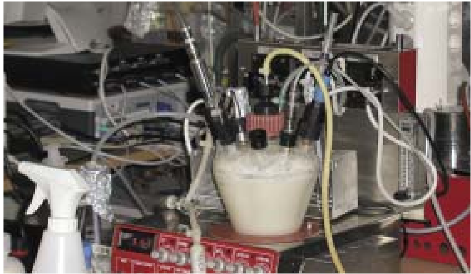
Domesticering av kontrolljäst i fermentor.
