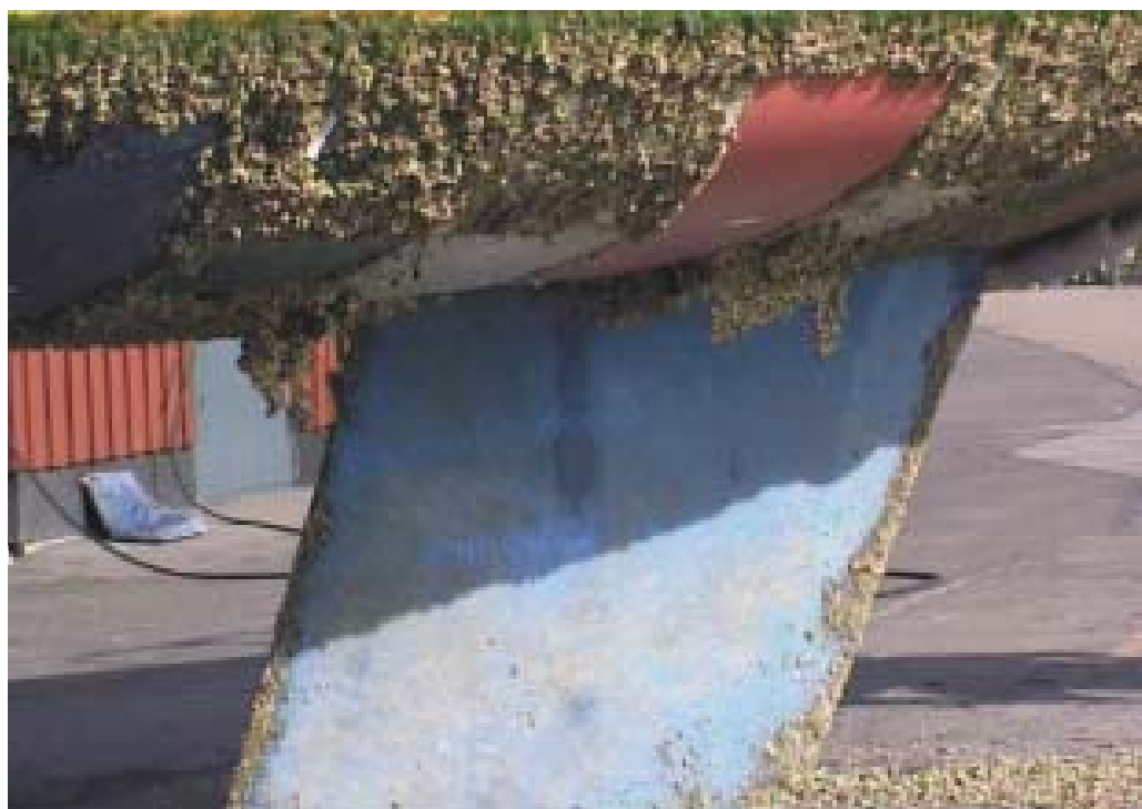
Havstulpaner på båtbottnen ökar energiförbrukningen. I programmet Marine Paint utvecklas en ny substans för att bli av med problemet.
